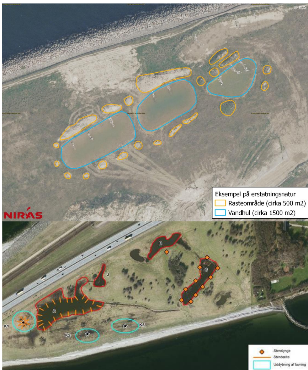
Figur 1: Øverst ses eksempel på anvendelse af sten og jordbunker i og omkring vandhuller med grønbroget tudse. Både stenbælter/høfder og stenklynger benyttes skjulesteder og rasteområder i og omkring nye vandhuller i Nordhavn, som er etableret i 2023. Nederst vises tilsvarende eksempel fra et projekteret anlæg på Sprogø /3/.
